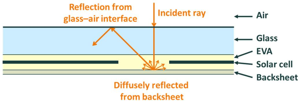
Fig. 3. Photovoltaic module section
