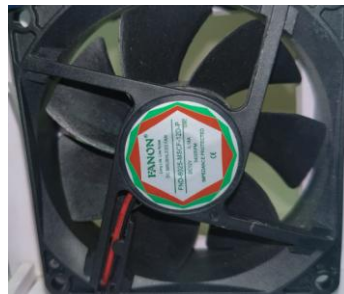
Fig.7. DC Motor Fan
