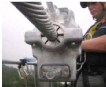
Fig. 7. Ampacimon monitor on conductor.
