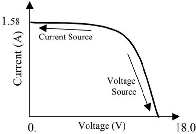
Fig. 5: PV Module IV
