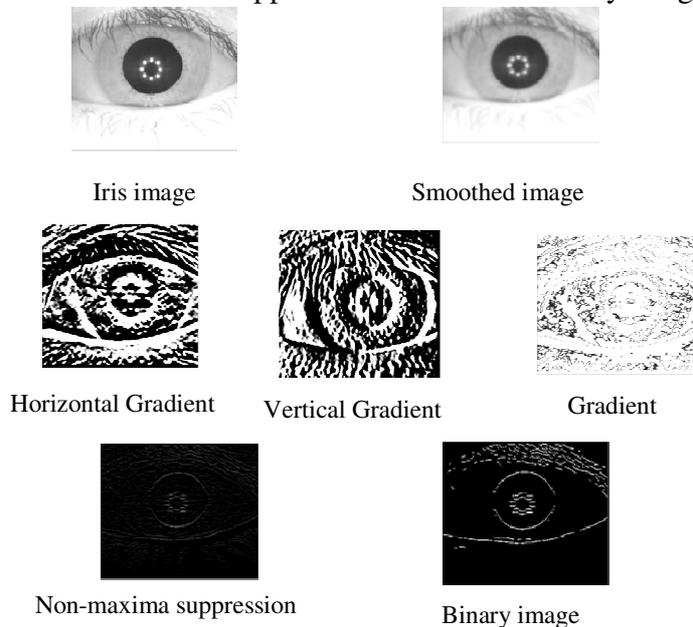
Fig.1. Edge map using Canny Edge detector.
