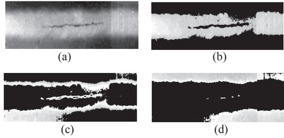
Fig.6. Clusters obtained after applying KFCM. (a) Original Image; (b) Cluster N° 1 ; (c) Cluster N° 2 ; (d) Cluster N° 3.
